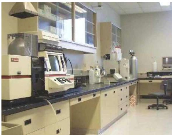
Gambar-7 Ruangan untuk Instrumen Canggih AAS
